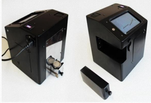
Şekil 15. Ca ve Mg elementlerinin analizi için otomatik titrasyon sistemi
