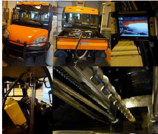
Şekil 2. Otomatik toprak örnekleme aracı (Özgüven, 2018).
