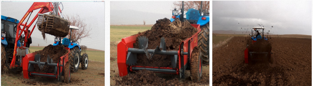
Şekil 1. Yatay tamburlu gübreyi geriye doğru dağıtma düzenine sahip makineler (Dursun, 2017)
