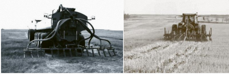
Şekil 12. Tankerli ve tankersiz sıvı ahır gübresi dağıtma makineleri (Dursun ve Dursun, 2019)
