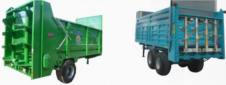
Şekil 3. Düşey tamburlu gübreyi geriye doğru dağıtma düzenine sahip makineler
