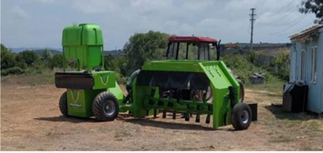
Resim 13. Karıştırıcı (çapalama) makinası
