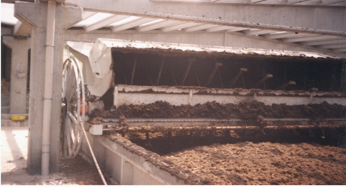
Resim 2. Kapalı Havuz (İn-Wessel) Kompostlama Sistemine Göre Organik Gübre Üretimi Aşamalarından Görünümler ve kapalı havuz yönteminde taze dışkı ile katkı materyallerinin karıştırılması
