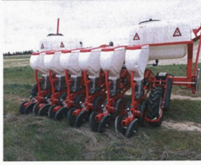
Şekil 9. Proje kapsamında geliştirilen ekim makinası ve sıvı formu gübre
