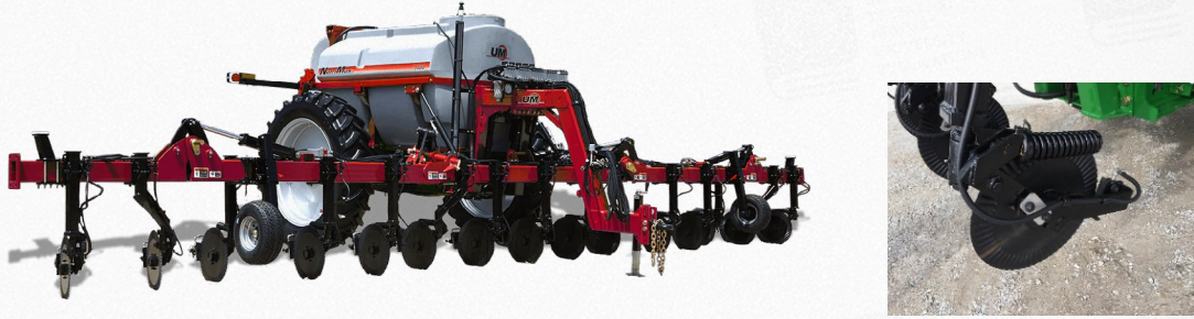
Şekil 33. Sıvı gübrenin toprak altına enjeksiyonu (Erol ve Gökür Dursun, 1998)
