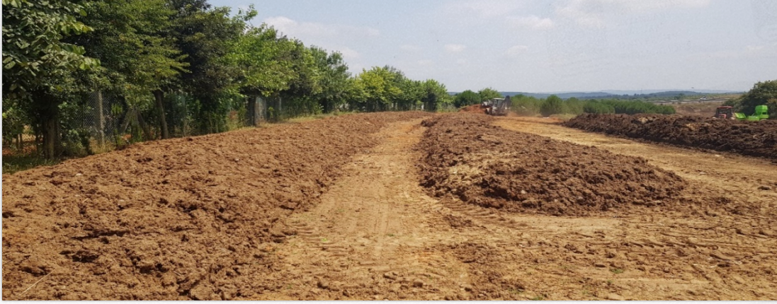
Resim 10. Sıralı yığın sisteminde oluşturulan ve çeşitli atıklardan temizlenen namlular
