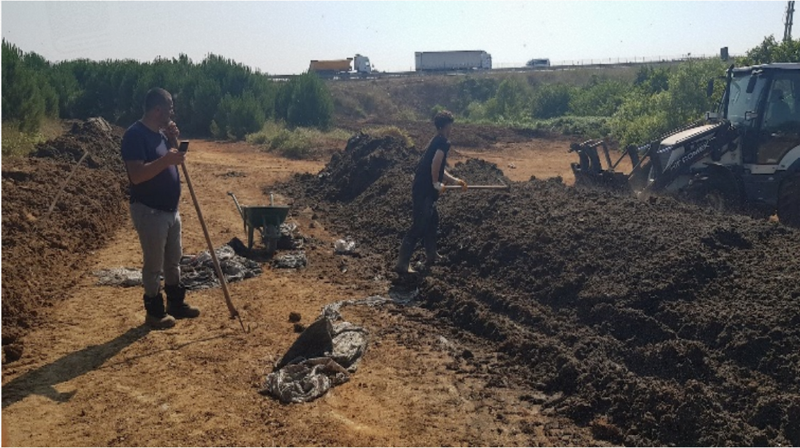
Resim 9. Sıralı yığın sisteminde oluşturulan namlularda atık yönetimi. Dışkılar içerisinde bulunan yabancı maddeler (çuval, pet şişe vb.) elle ayıklanıyor.
