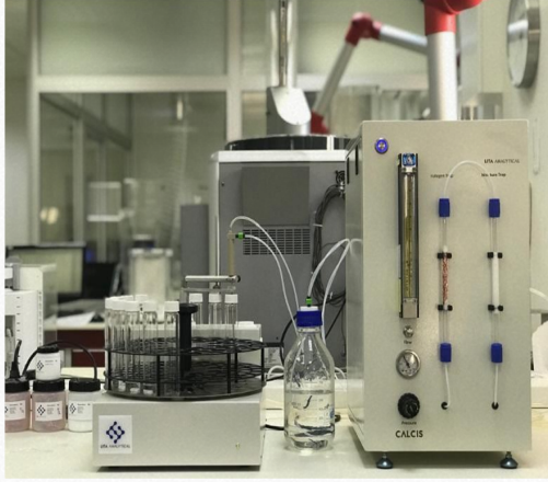
Şekil 15. Ca ve Mg elementlerinin analizi için otomatik titrasyon sistemi
