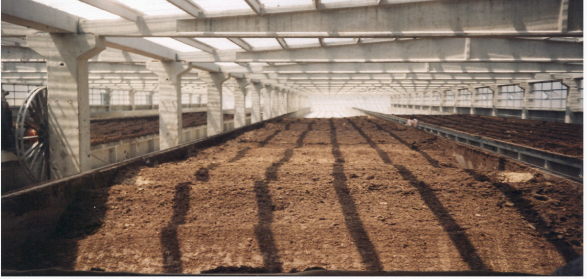
Resim 1. Kapalı havuz yönteminde hayvan dışıklarının kompostlanması
