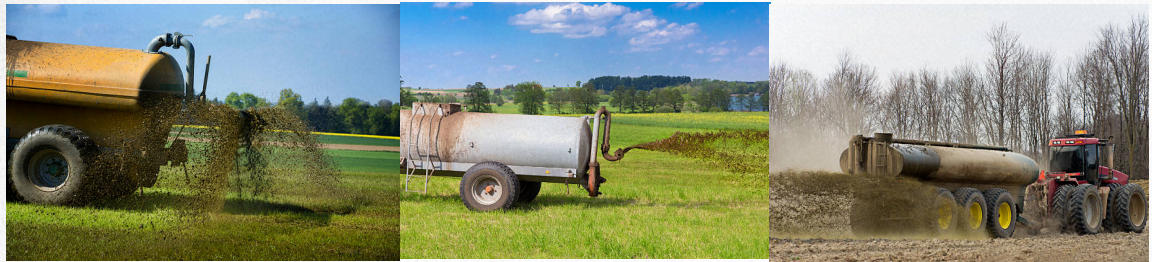
Şekil 11. Sıvı Ahır Gübresi Dağıtma Makinelerinin tarlada gübre dağıtımı
