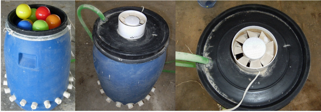
Şekil 1. Amonyak tutma düzeneği (Coşkan ve Atılgan, 2018)
