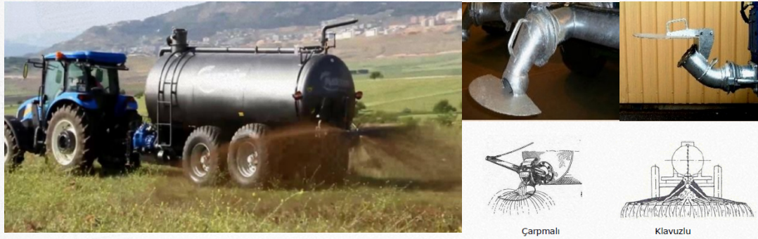
Şekil 9. Kompresörlü Sıvı Ahır Gübresi Dağıtma Makinesi (Dursun, 2017)
