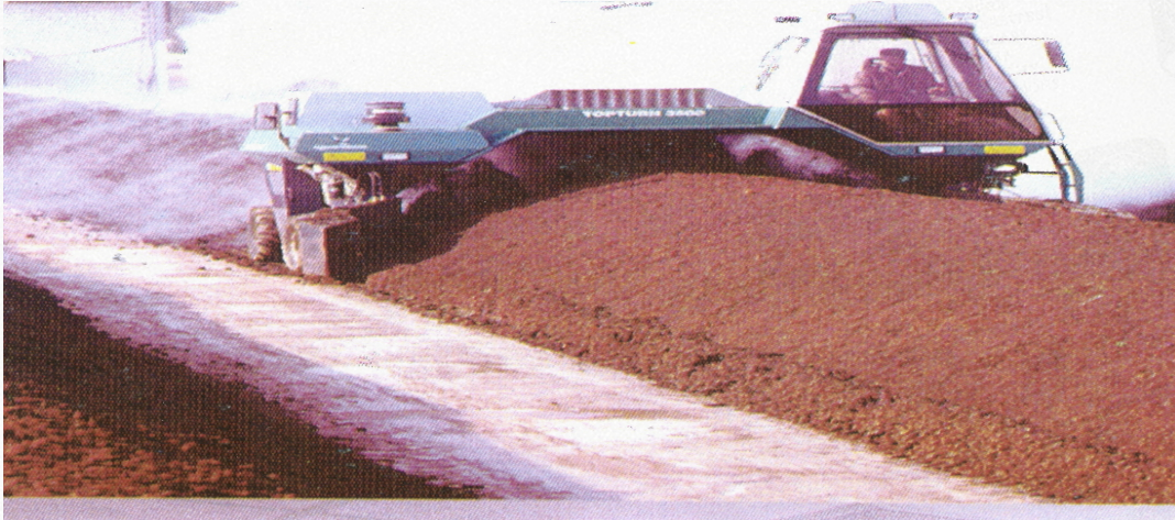
Resim 6. Sıralı yığın kompostlama yönteminde hayvan dışkıları ile yapılan yığınlar ve karıştırılmaları
