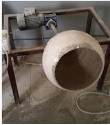
Şekil 42. Hacıyusufoğlu ve ark. (2015) tarafından kullanılan tohum kaplama düzeneği
